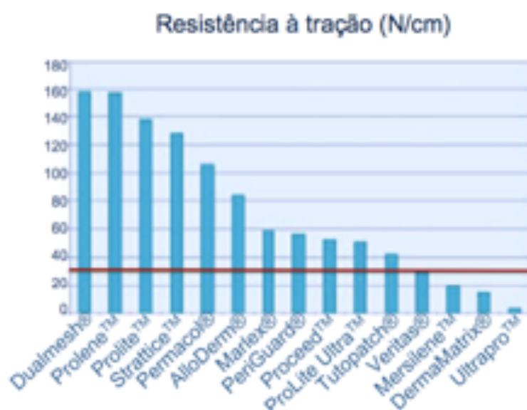
Figura 9. Comparação da resistência à tração de diferentes telas comerciais. A linha vermelha indica a força de tração mínima exigida pela tela para sustentar o reparo da hérnia (32 N/cm).
