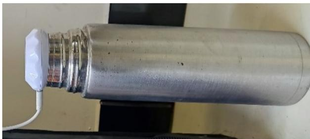
Figura B.1. Conjunto de nebulização da água para gerar umidade no ambiente interno da estufa *indoor*.
