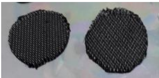
Figura 8: Amostras do tecido de fibra de carbono cortadas de forma circular.
